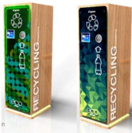
Автомат по приёму тары (Reverse vending machine) - роботизированный агрегат, выменивающий вторичную (возвратную) тару: алюминиевые банки и бутылки из полиэтилентерефталата (ПЭТ) у населения в обмен на небольшое денежное вознаграждение. «Умный» приемный контейнер определяет вес и объем тары, а сканер способен распознавать 30 тысяч штрих-кодов и позволяет точно идентифицировать объект.
